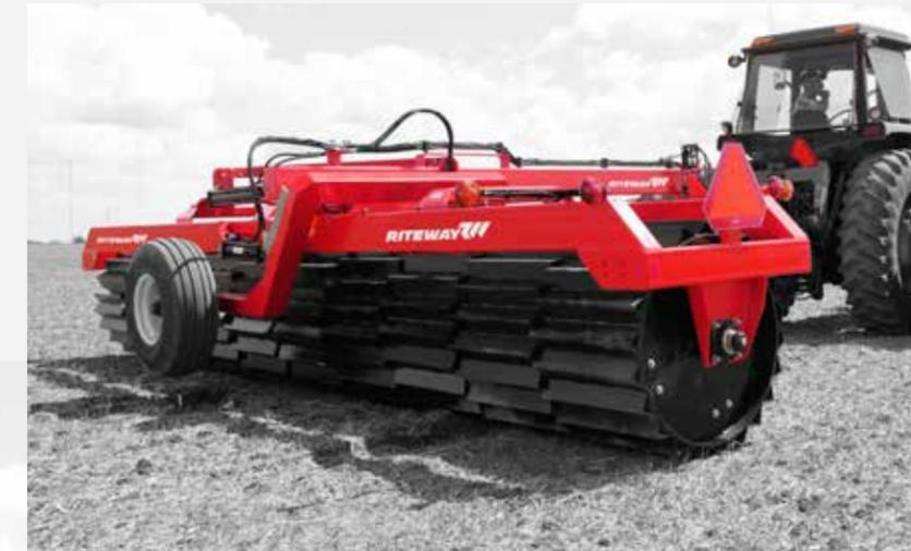
*Crush-Rite* weist alle Merkmale unserer Ackerwalzen auf – einschließlich des patentierten **FORWARD™**-Aufklappsystems. Zudem verfügt sie über Schneideklingen, die Unkraut zerdrücken und Gründüngung niederwalzen oder quetschen, um diese in eine Nährstoff liefernde, den Boden schützende Decke zu verwandeln.
